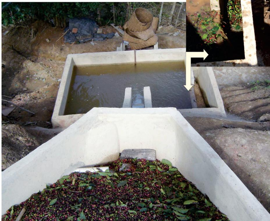
Construída em alvenaria, é de operação muito simples e possibilita a obtenção de dois lotes bem distintos de café.
